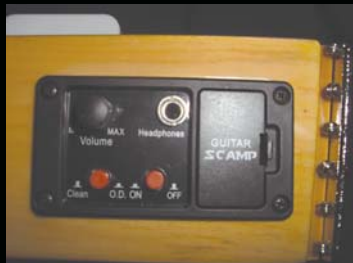
ギターに内蔵されたヘッドホン・アンプ。ヘッドホンを使用する時にONにする。クリーン・サウンドとオーバードライブ・サウンドの切替スイッチもあるので便利。右側は電池収納ケース
