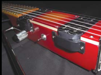
LESTAR II ボディ上部に見えるミニ・スイッチはピックアップ・セレクター。フロント/ミックス/リアの切替ができる
